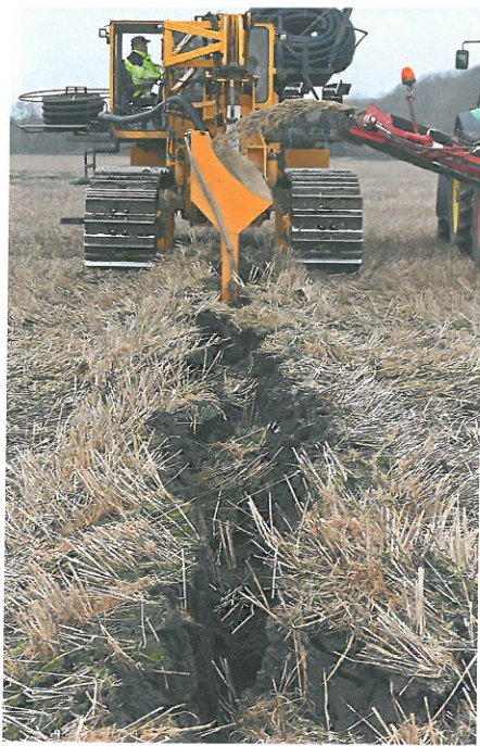
■ L-ploven kan udbygges med en efterfølgende kasse, så den i samme arbejdsgang lægger grus omkring drænrøret.
